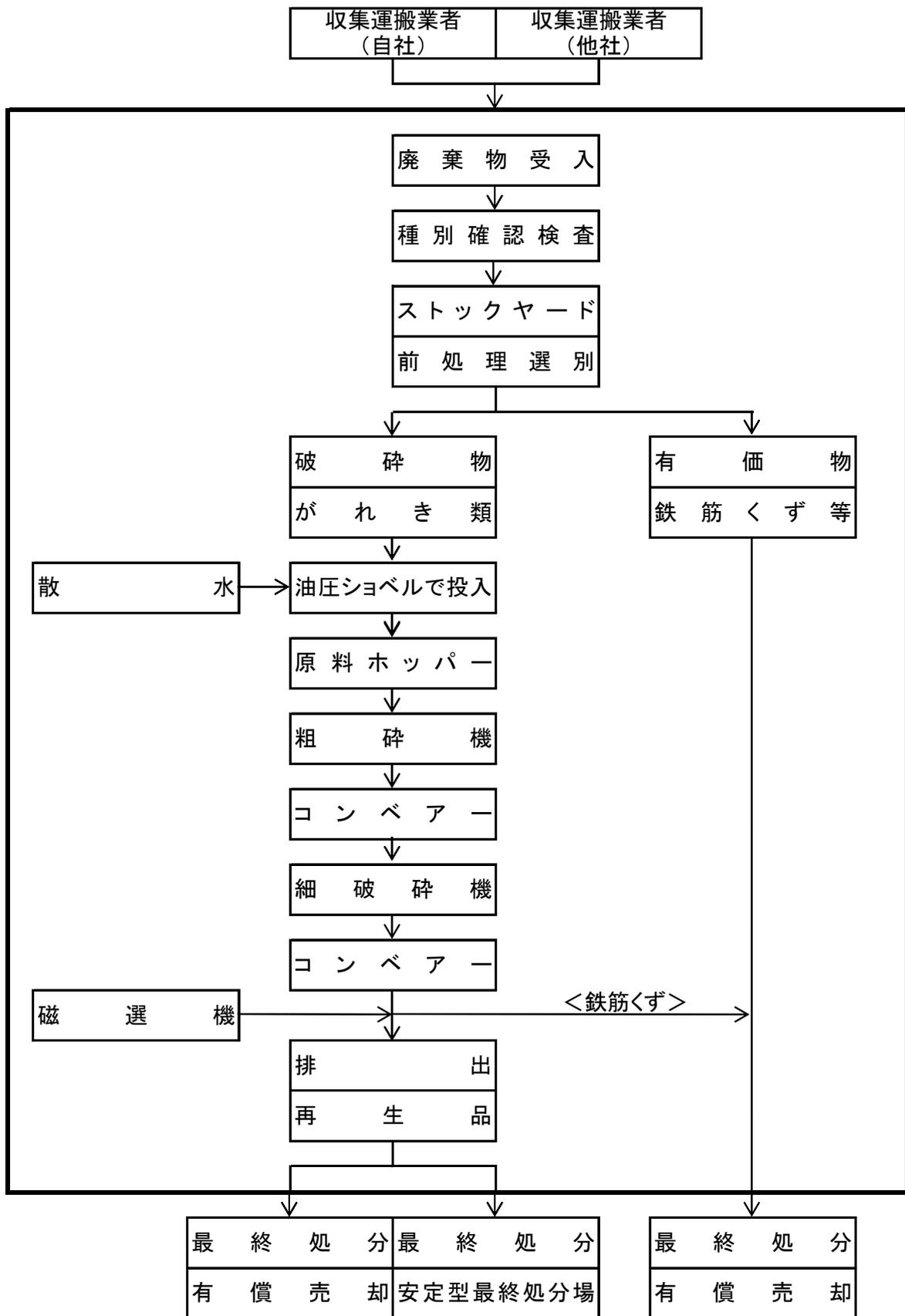
移動式破碎処理工程図(がれき類)
